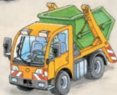
autoîncăcător hidraulic cu brațe mobile
