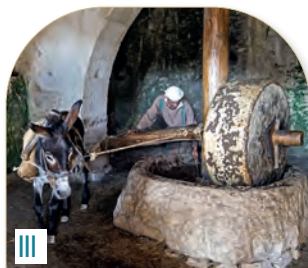
III Piatră de moară folosită la presarea măslinelor pentru obținerea uleiului
