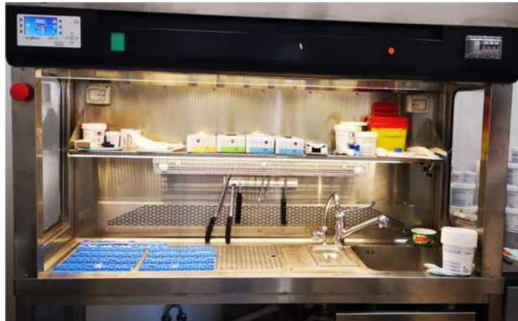
Fig. 1. Nișa chimică cu exhaustare totală și post de lucru
