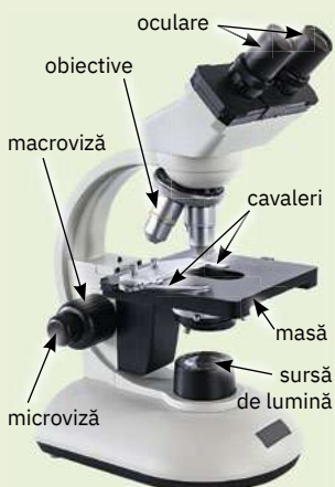
Părțile componente ale unui microscop
