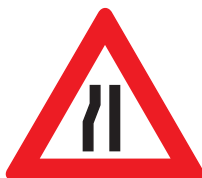
Drum îngustat pe partea stânga
